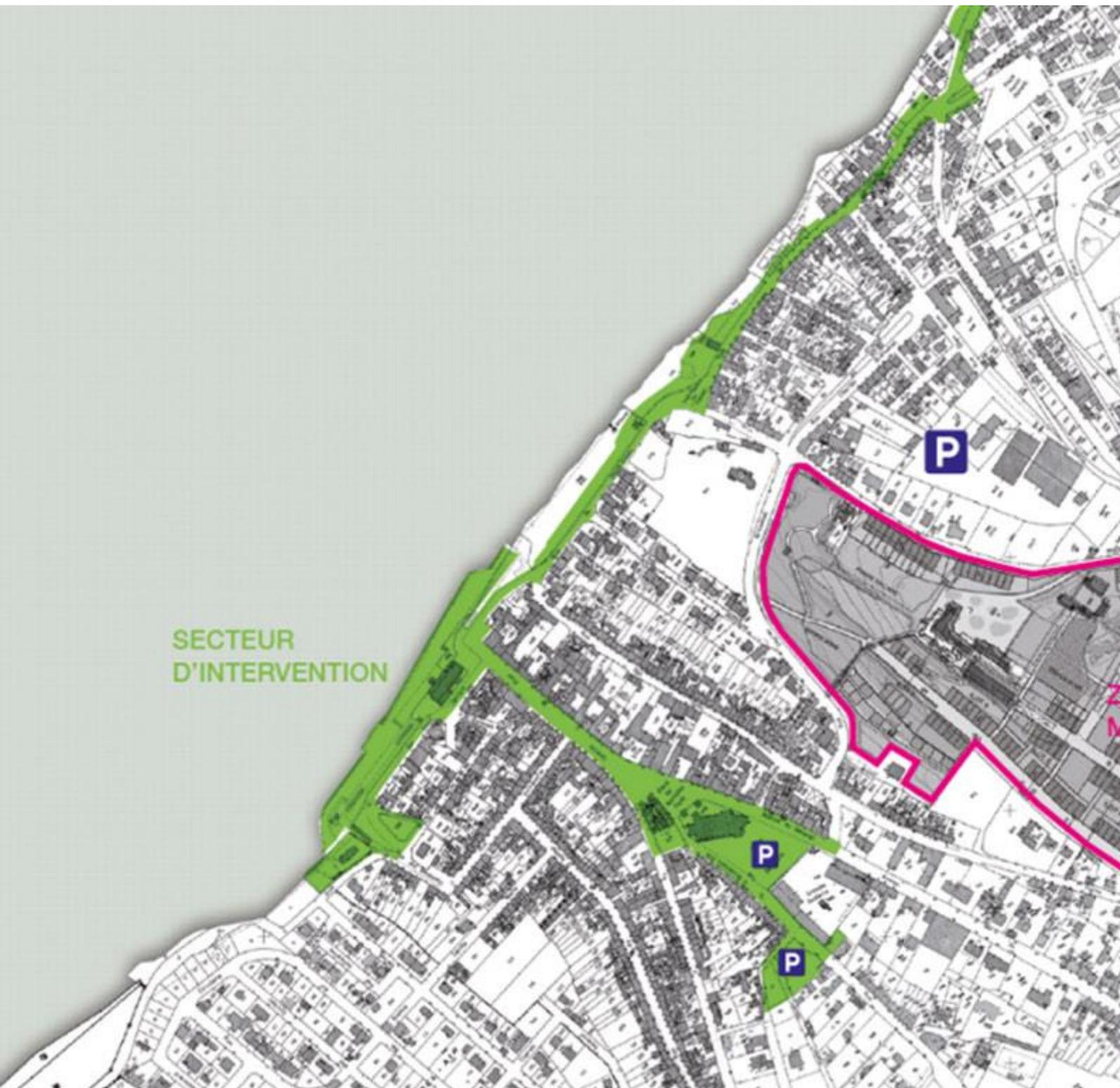
Le risque d'effondrement par bloc de falaise est pris en compte tant en termes de réfection des réseaux qu'en termes d'aménagement qualitatif. La réfection des réseaux d'assainissement et d'éclairage précéderont les travaux d'aménagement de surface. La requalification qualitative et attractive des espaces publics prévoit un espace dévolu aux piétons plus généreux. Enfin, à une échelle de périmètre de projet étendu, le nombre d'emplacements de stationnement destinés aux
