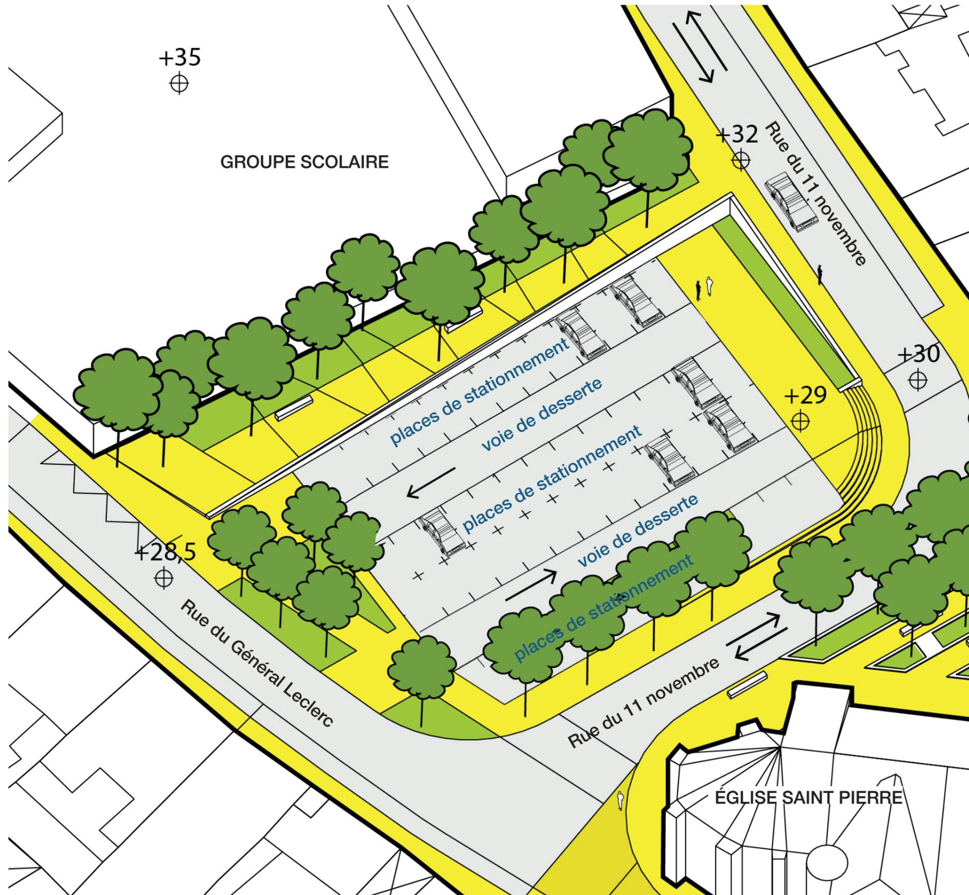
↑ schémas axonométrique des principes du réaménagement de la place De Gaulle
